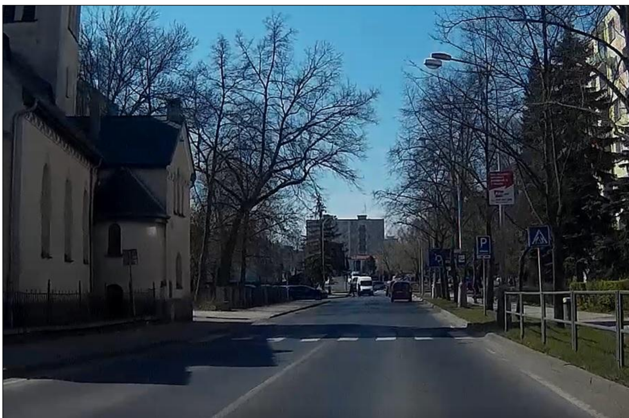
Obrázek 15: Lokalita 209-01 – Chodov – přechod pro chodce jižně od okružní křižovatky (pohled ze severu) – značka č. IP 6 se „ztrácí“ v množství dalších značek a reklam.
