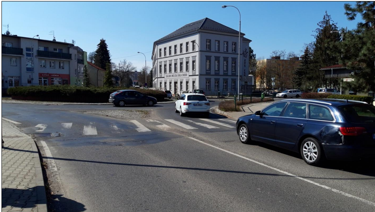
Obrázek 13: Lokalita 209-01 – Chodov – vjezd do okružní křižovatky ze silnice II/222 ze severu – nedostatečně označený a dlouhý přechod pro chodce, neviditelný okraj okružního pásu.
