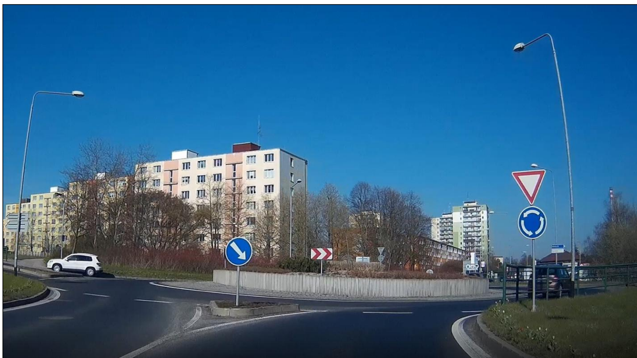
Obrázek 38: Lokalita 2099-02 Sokolov, Závodu míru – okružní křižovatka ve směru od dálnice (nebezpečná svislá betonová stěna středního ostrova, vpravo zbytečné zábradlí)
